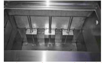
Lavaggio stampi per materie plastiche di precisione per industria, modellismo e giardinaggio. Nella foto i nostri potenti trasduttori IMMERSIBILI in acciaio inox 316 L, serie ULTRAPEZIO HIGH-POWER
