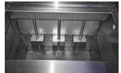
Lavaggio stampi per materie plastiche di precisione per industria, modellismo e giardinaggio. Nella foto i nostri potenti trasduttori IMMERSIBILI in acciaio inox 316 L, serie ULTRAPIEZO HIGH-POWER
